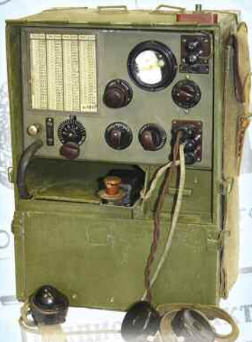
КВ радиостанция 13-Р (СССР, 1942 г.)
