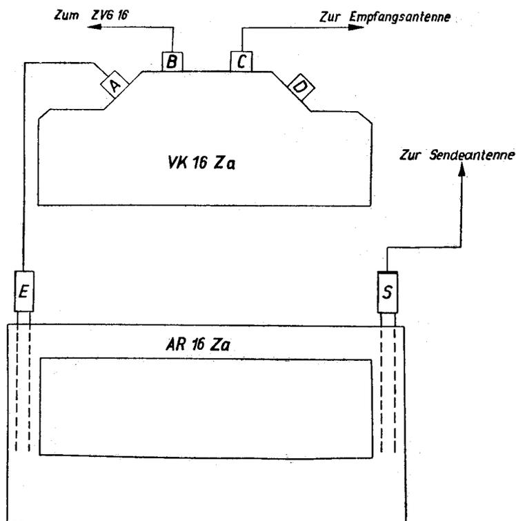
**Abb. 1: Anschluß der HF-Leitungen am VK 16 Za und AR 16 Za
