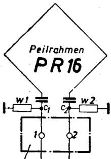
Bei Einbau des Peilrahmens unter den Flugzeugrumpf ist Rahmenerleitung 1005F entgegen der Darstellung mit Ader „sw“ an Klemme 1 mit Ader „rt“ an Klemme 2 zu legen
