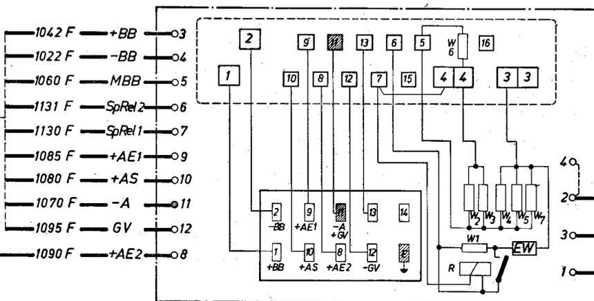
Brücke von Klemme 2 nach 4 bei Montage einlegen.
