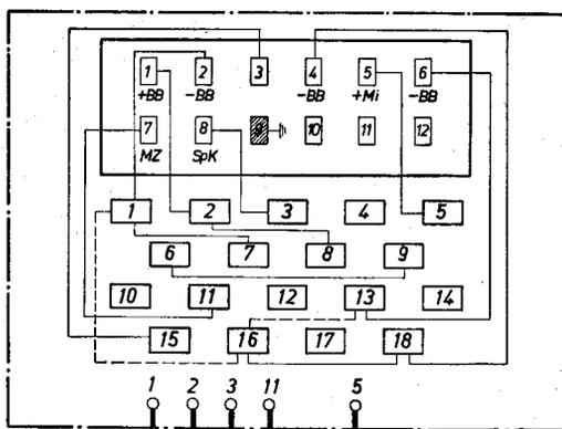
Brücken von Klemme 1 nach 16 und 16 nach 13 bei Montage einlegen
