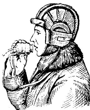
Рис. 159. Положение микрофона во время передачи.
